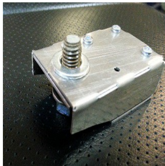
Фото №5,6 Форестер 08 и импреза ГН — установлен штатный g-сенсор на место. Обращаем внимание, необходимо использовать шайбу под корпусом g-сенсора.
